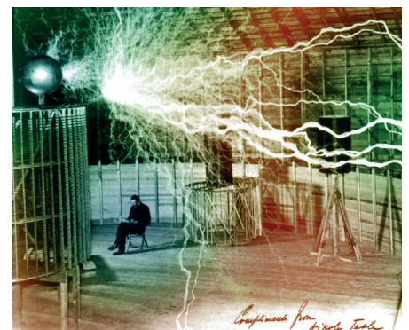
Nikola Tesla – der Herr der Blitze! Entladung einer gewaltigen Spule in Teslas Laboratorium in Colorado Springs. Vertieft in seine Arbeit sitzt Nikola Tesla neben seiner Erfindung und macht Notizen. (Doppelbelichtung)
